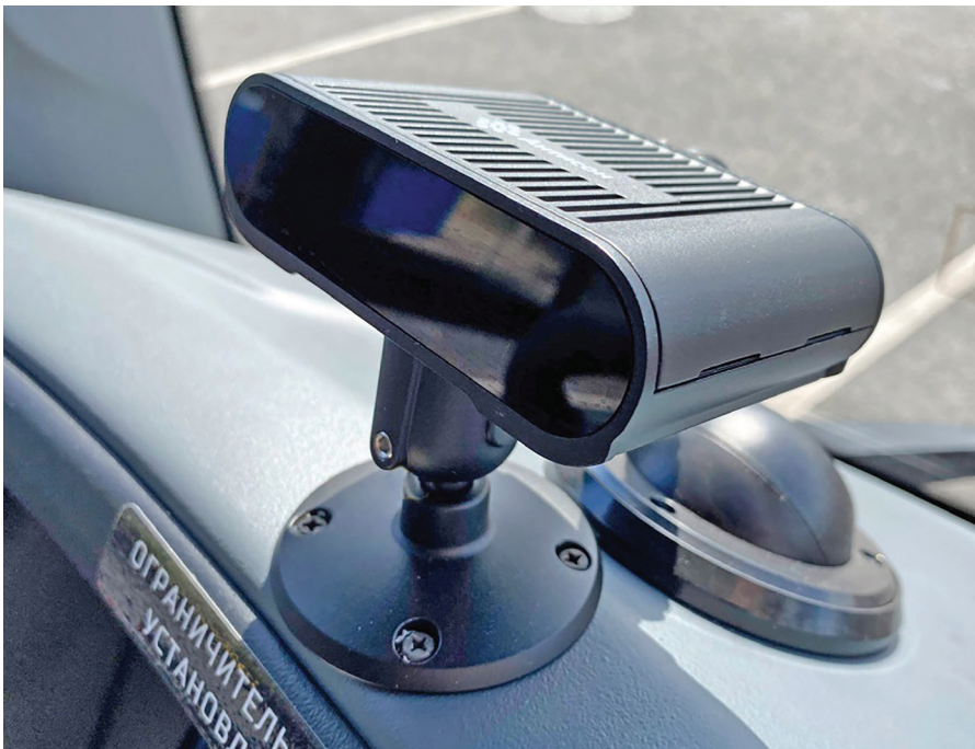
Бесконтактная автономная система «Антисон» позволяет мониторить состояние водителя на основе искусственного интеллекта
